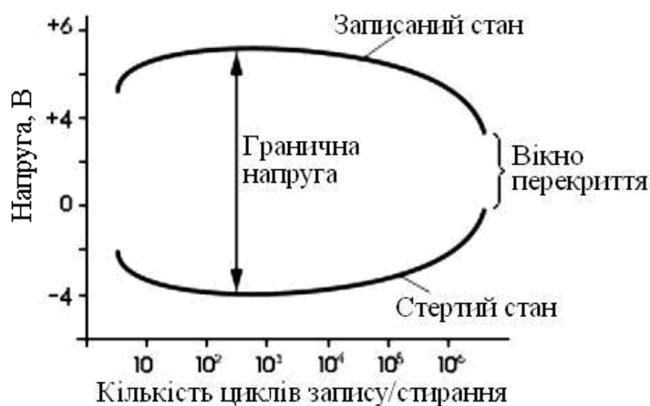
Рис. 1. Залежність значення граничної напруги від числа циклів запису та стирання комірок матриці флеш-пам'яті.
