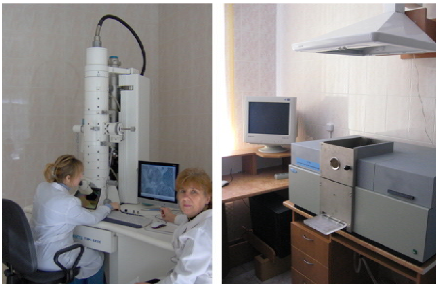
Фото 5. Наукова лабораторія інституту. Електронний мікроскоп з програмним забезпеченням, атомно-адсорбційний спектрофотометр.
