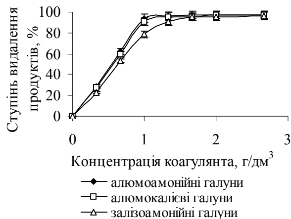
Рис. 2. Залежність рівня видалення продуктів окиснення фенолу від концентрації коагулянта (С фенолу 0,5 ммоль/дм 3 , температура 25 °С, рН 6,5, \tau 3 год).
